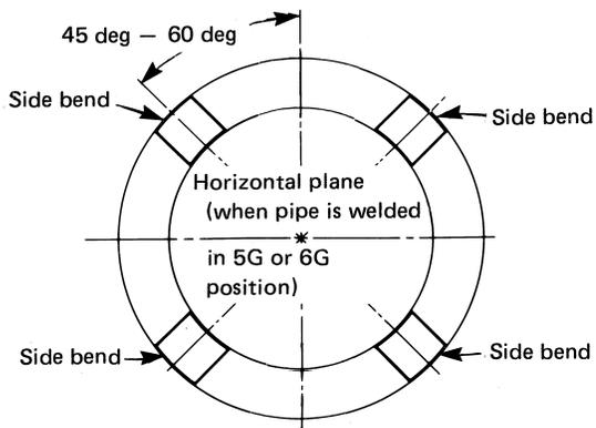
QW-463.2(f) PIPE — NPS 10 (DN 250) ASSEMBLY PERFORMANCE QUALIFICATION
