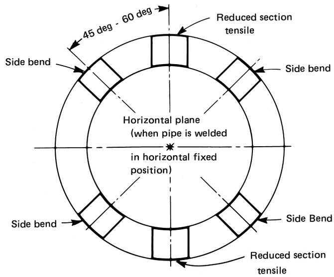
QW-463.1(f) NOTCH-TOUGHNESS TEST SPECIMEN LOCATION
